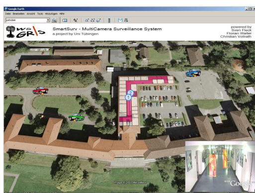
Abbildung 3: Ein Kamera-Knoten kann gleichzeitig fünf Objekte verfolgen (links). Im finalen SmartViz-Knoten sind die verfolgten Objekte als Live-Texturen in Google Earth eingebettet (rechts unten).
