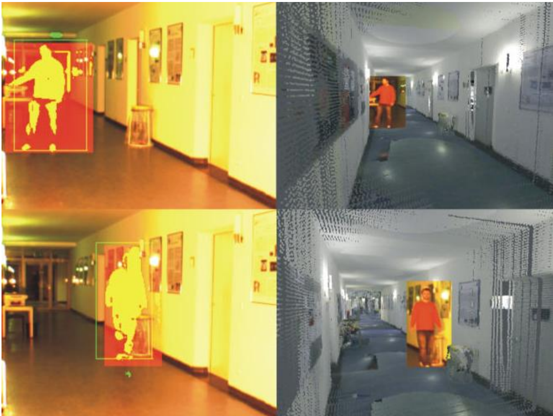
Abbildung 5: Eine Rohkamera mit dem Overlay des Ergebnisses der Verfolgung (linke Spalte). SmartViz Visualisierung zeigt die verfolgte Person als Live-Textur in einem gerenderten 3D-Modell (rechte Spalte).
