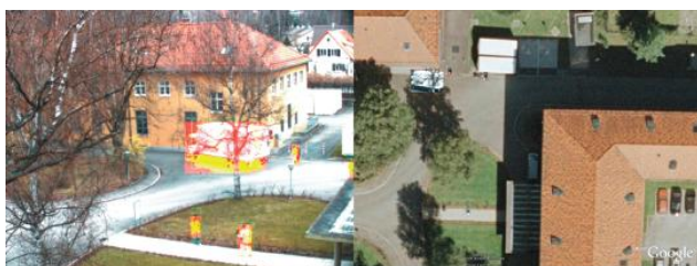
Abbildung 2: SmartSurv System mit fünf Kameras, welches drei Autos und zwei Personen verfolgt, dargestellt als stilisierte Icons (rechts). Die SmartViz Frontend ist das, was der Benutzer sieht: das Live-Video der intelligenten Kamera mit dem Overlay des Ergebnisses auf der linken Seite. Dieses Feature kann zwecks Datenschutz und Einsparung von Bandbreite ausgeschaltet werden.
