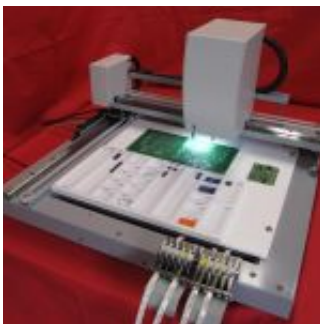
Montage de composants SMD de type « bureau »
