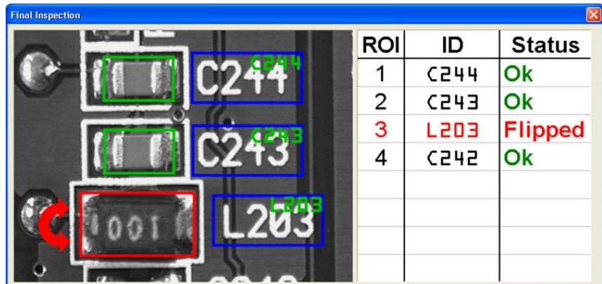
Mit dem Softwarepaket mvRapidIMPACT wird durch erstellen bzw. Konfigurieren einer Taskliste ein Prototyp der BV-Applikation erstellt.
